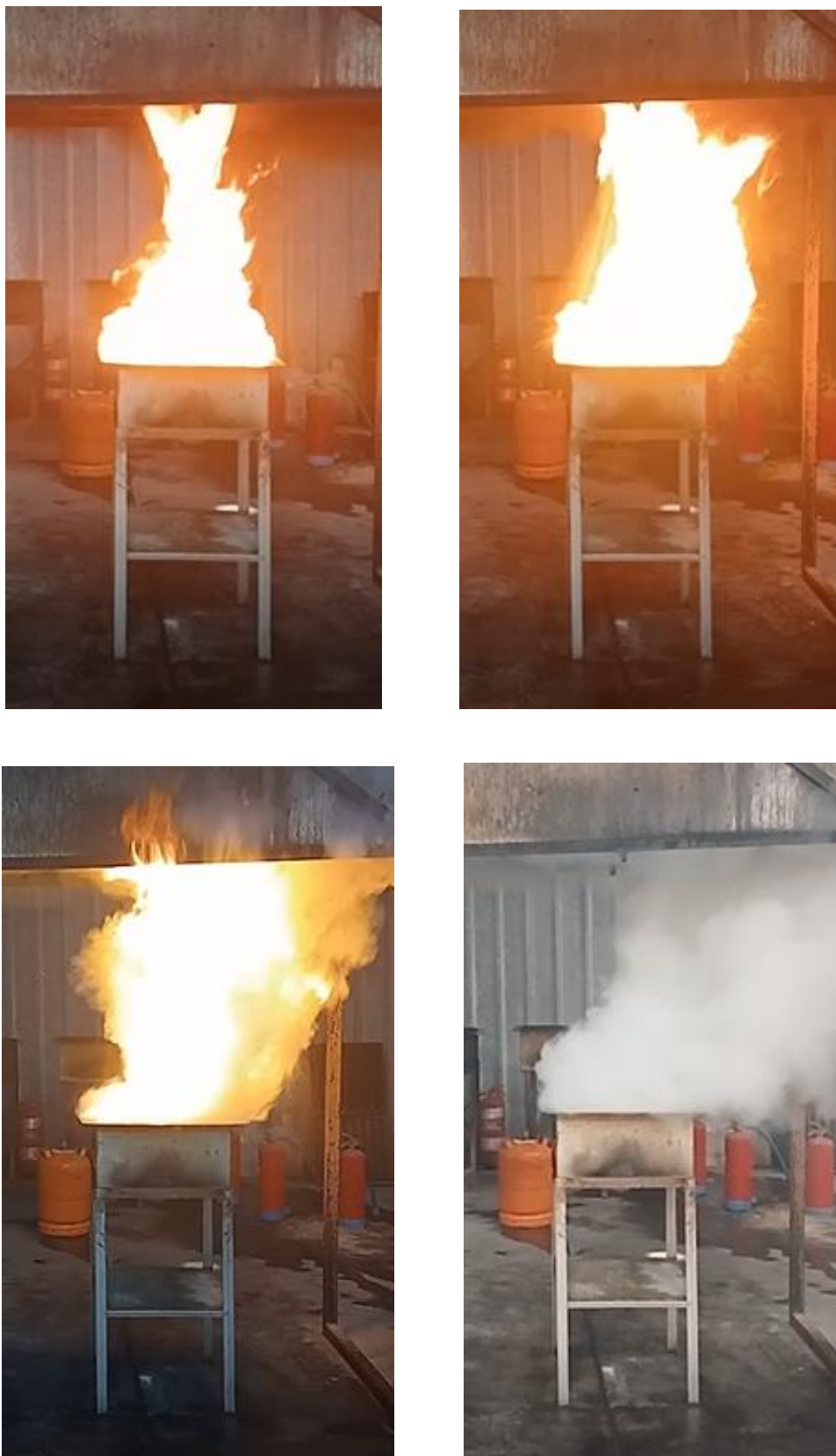
Fig. 3: Secuencia extinción freidora (5 segundos entre inicio y fin)
