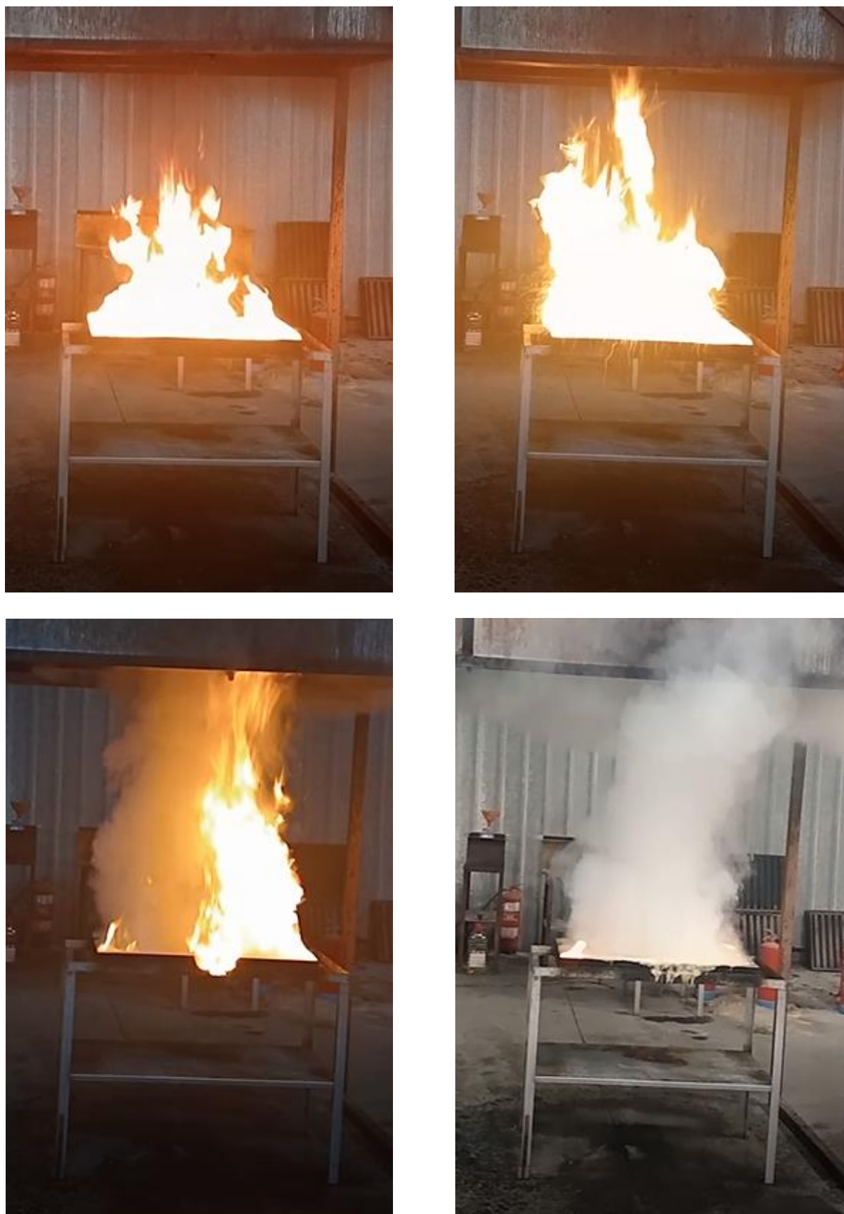
Fig. 4: Ensayo extinción plancha. 35 segundos entre inicio (previo descarga) y fin (posterior a la extinción)
