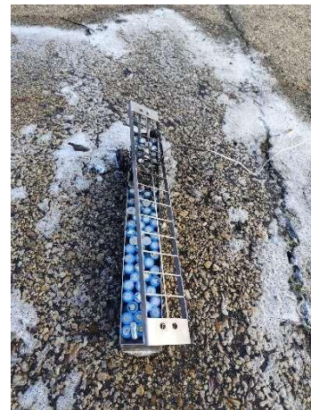
Figura 13: Estado de la batería después del ensayo 2
