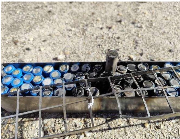
Figura 9: Estado de la batería después del ensayo 1
