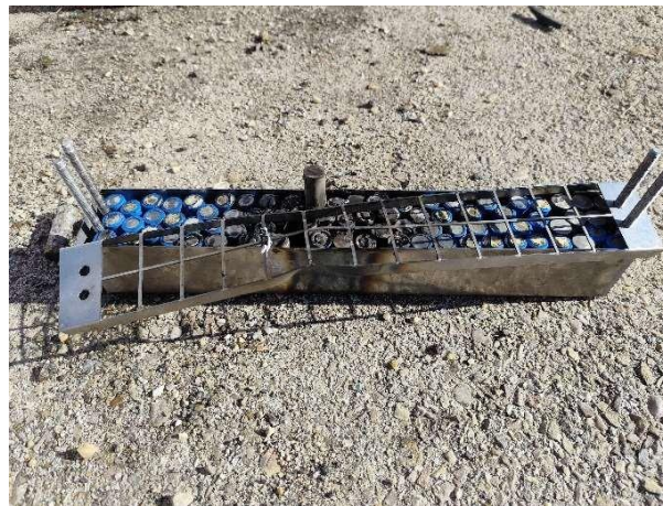
Figura 9: Estado de la batería después del ensayo 1
