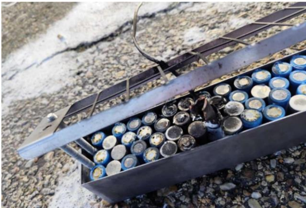
Figura 13: Estado de la batería después del ensayo 2
