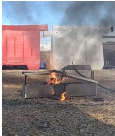
Figura 7: Batería en reacción ensayo 1
